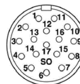
Polbild Buchsenstecker mit Außengewinde 19-polig Ansicht auf Steckseite
